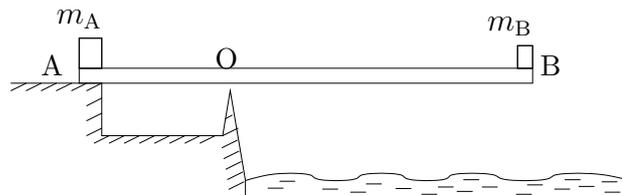
4. Du fait du nouveau support en  $A$ , une réaction  $\vec{R}_A$  vient s'ajouter aux forces identifiées dans la partie précédente. Justifiez que si la planche est à l'équilibre, la composante verticale  $R_{Az}$  est nécessairement positive ou nulle.
