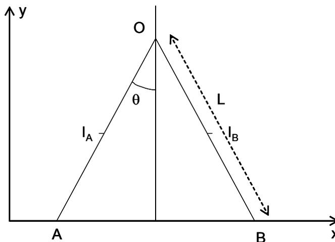
*Considérons une échelle double constituée de deux échelles simples identiques (OA) et (OB) de masse  $m=20$  kg chacune et de longueur  $L=10$  m. On appelle respectivement  $I_A$  et  $I_B$  les milieux (et centres de gravité) de OA et OB. Les deux échelles sont posées l'une contre l'autre en O, avec un demi-angle au sommet  $\theta=30^\circ$ . Le sol est considéré comme parfaitement lisse et donc sans frottement.*
