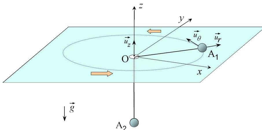
Le mouvement des boules est observé dans le référentiel du laboratoire  $\mathcal{R}$ , supposé galiléen, et muni d'un système de coordonnées d'origine O (voir figure). La position de la boule 1 est repérée par le vecteur  $\vec{r} = \overrightarrow{OA_1}$ . On notera  $r$  et  $\theta$  les coordonnées polaires du point  $A_1$  et  $z$  l'altitude du point  $A_2$ .
